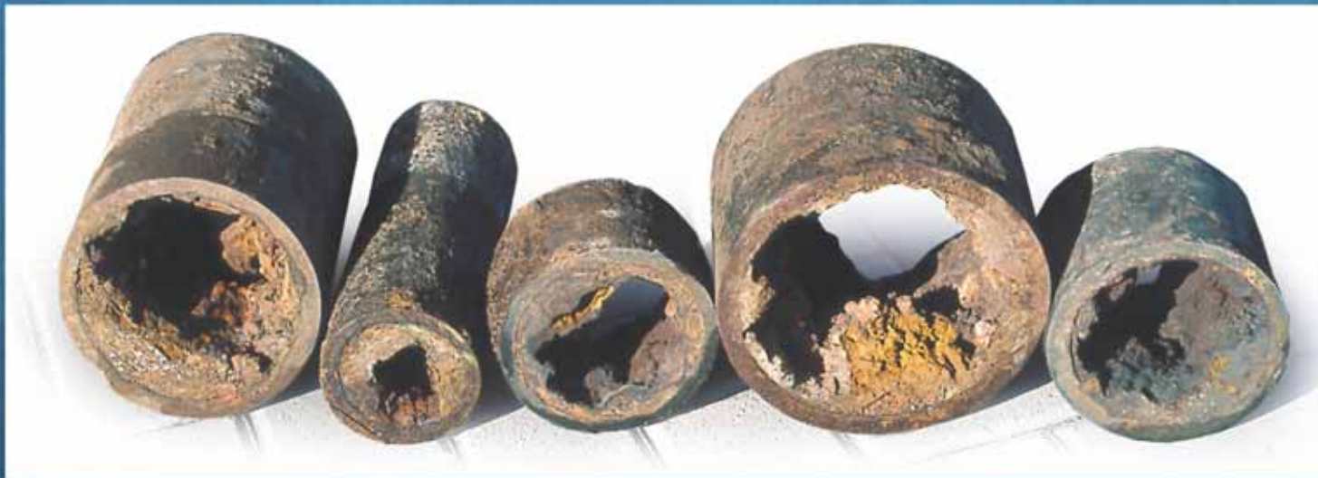
Rohrschnitt typischer Nordhäuser Gussrohrleitung mit Inkrustierung
